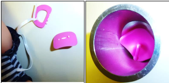
Abbildung 5.4: Das Mundstück eines Puppenschnullers brach bei der Schlagprüfung ab.
