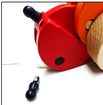
Abbildung 5: Abgelöste und verschluckbare Bestandteile der überprüften Spielzeuge (Bilder 1 bis 5)
