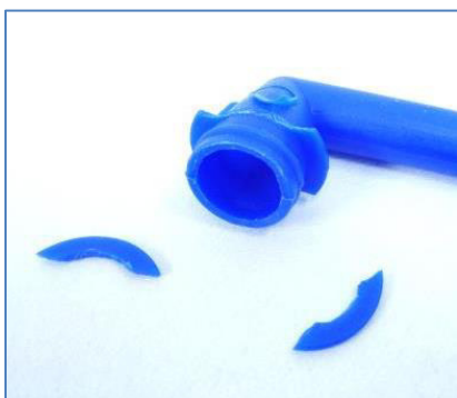
Abbildung 3: Abgebrochene Teile eines Spielzeugs, die vollständig in den „Schluckzylinder“ passen.
